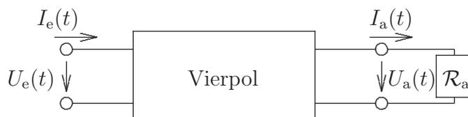
Einen (linearen) Vierpol nennen wir **konventionell**, wenn eine Matrix-wertige Funktion  $\mathbb{M}(\omega)$  existiert, deren Elemente rationale (komplex-wertige) Funktionen von  $\omega$  sind, mit der für die FOURIER-Transformierten der reellen Ströme und Spannungen **stets** die Beziehungen
